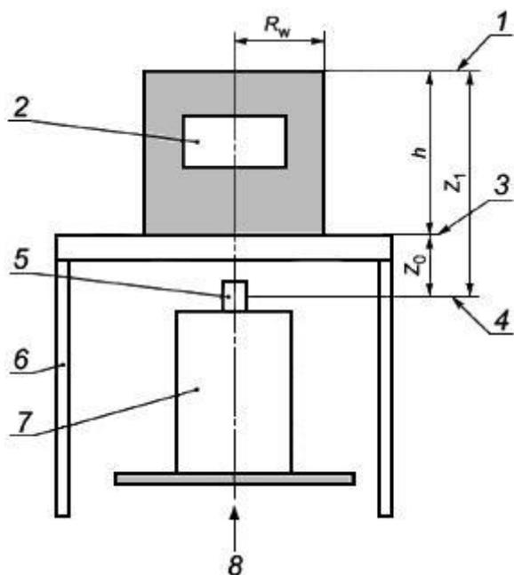
1 - верх гири; 2 - гиря; 3 - основание гири; 4 - середина магнита по высоте; 5 - магнит; 6 - стол; 7 - опорная стойка; 8 - грузоприемная платформа компаратора масс;  $h$  - высота гири;  $z_1$  - расстояние от верха гири до середины магнита по высоте;  $z_0$  - расстояние от середины магнита по высоте до основания гири;  $R_w$  - радиус гири
