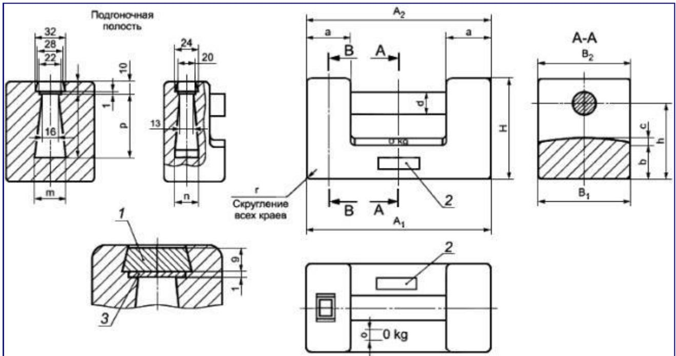
1 - свинцовая пластина; 2 - клеймо изготовителя; 3 - маленькая пластинка из мягкой стали
