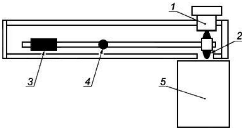
1 - стандартный образец; 2 - стержневой магнит; 3 - противовес; 4 - шарнир; 5 - гиря
