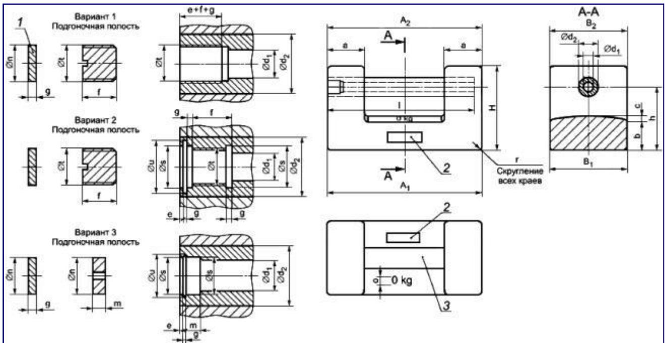
1 - свинцовая пластина; 2 - клеймо изготовителя; 3 - трубчатая ручка
